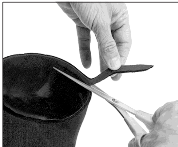
Trimming av neopren Halstetning (Neckdam)
